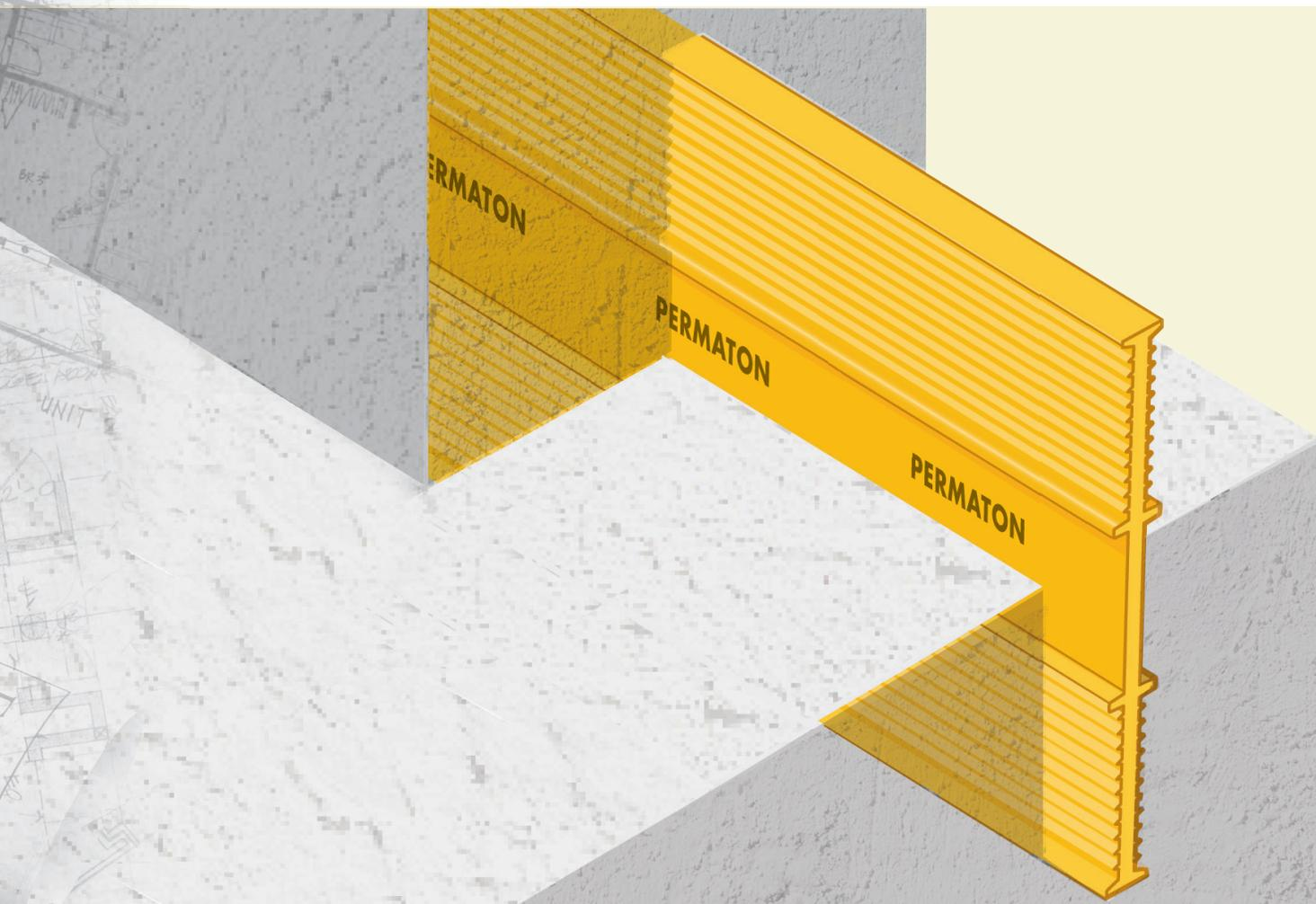
PERMATON®-Fugenbänder aus thermoplastischem Kunststoff (PVC-P) dienen der wasserundurchlässigen Abdichtung von Arbeitsfugen im Stahlbetonbau.
